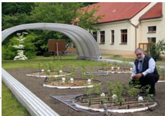
Das „Drylab“ in Eberswalde. Das sensorgesteuerte Dach schiebt sich bei Regen automatisch über die jungen Bäume.
