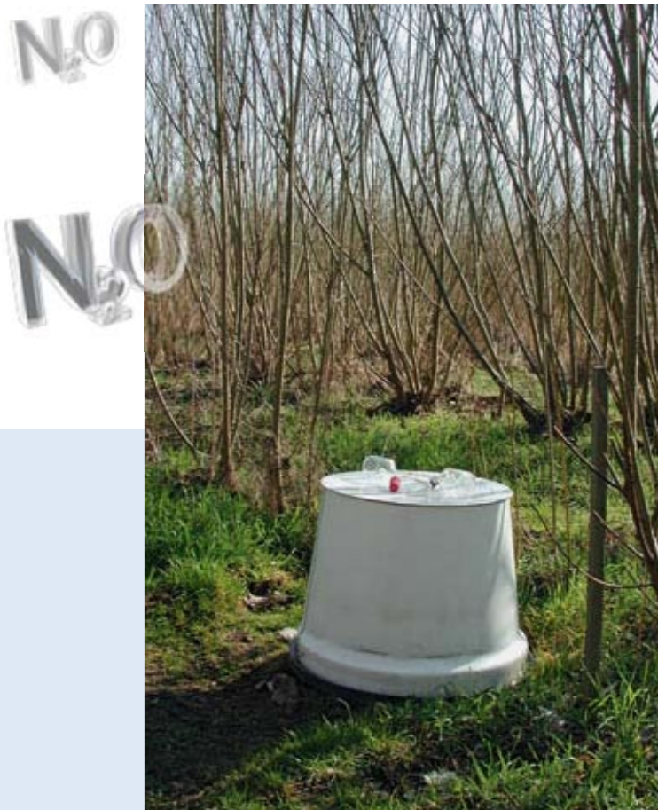
Abb. 4: Messhauben zur Erfassung der N_2O -Emissionen in Kurzumtriebsplantagen
