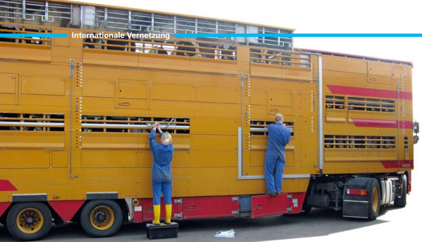
Ausstattung eines Versuchsfahrzeuges für den langen Transport von Rindern mit Messensoren. (Abbildung aus dem Verbundprojekt FLITiHo-Hannover zum Mikroklima beim Tiertransport)
