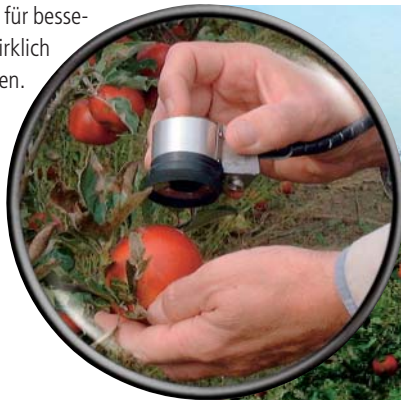
Abb. 1: Rucksack-Spektrometer: Bereits am Baum kann der Reifezustand von Äpfeln zerstörungsfrei von außen bestimmt werden.
