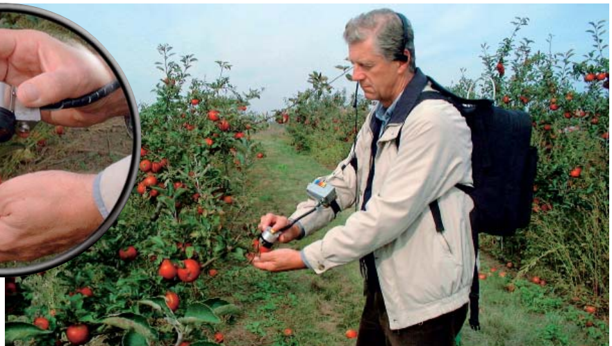
Abb. 1: Rucksack-Spektrometer: Bereits am Baum kann der Reifezustand von Äpfeln zerstörungsfrei von außen bestimmt werden.
