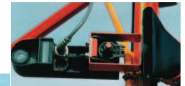
Innovative Lösung: Injektordüsen für Feldspritzgeräte minimieren die Abdrift bis zu 90 Prozent.
