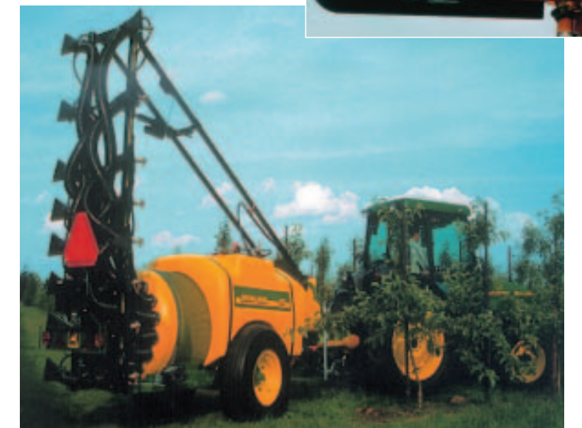
Deutliche Entlastung der Umwelt: Bis zu 30 Prozent der Pflanzenschutzmittelmengen im Obstbau können durch sensorgesteuerte Sprühgeräte eingespart werden. Kleines Bild: Düse-/Sensor-Einheit.
