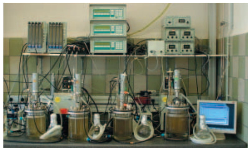
Bioreaktoren zur Kultur pflanzlicher Zellsuspensionen mit einem Arbeitsvolumen von zwei Liter (links) bzw. fünf Liter (rechts) mit den dazugehörigen Mess- und Regeleinrichtungen.
