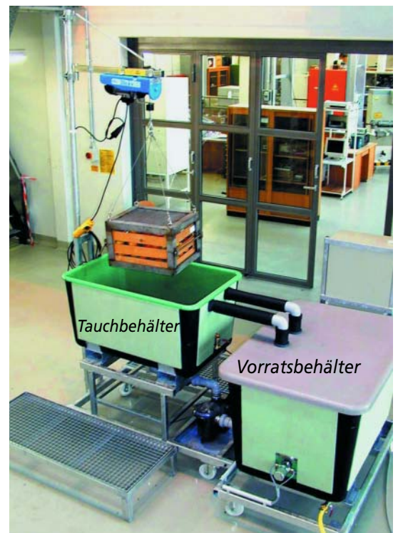
Abb. 2: Heißwassertauchanlage zur Behandlung von Äpfeln in 20 kg Obstkisten.
