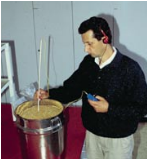
Abb. 1: Früherkennung von Insektenbefall im Getreide durch akustische Spurensuche
