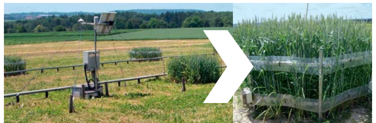
Abb. 1: FACE-System für Feldexperimente mit erhöhtem CO 2 in der Atmosphäre an der Universität Hohenheim. Die CO 2 -Konzentrationen innerhalb der Versuchsfelder betragen entweder 380 ppm (derzeitige Konzentration) oder 550 ppm (zukünftige Konzentration).
