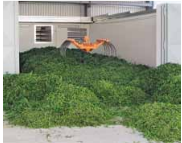
Abb. 2: Energieeffiziente Raumnutzung. Die Trocknung des Ernteguts erfolgt in geschlossenen Boxen; der zu erwärmende Raum ist damit deutlich verringert. Links: Trocknung von Kamilleblüten, rechts: Trocknung von Melisse bei der Agrarprodukte Ludwigshof e.G. in Thüringen.
