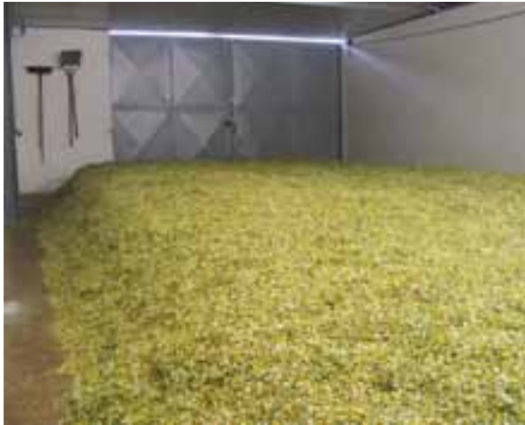
Abb. 2: Energieeffiziente Raumnutzung. Die Trocknung des Ernteguts erfolgt in geschlossenen Boxen; der zu erwärmende Raum ist damit deutlich verringert. Links: Trocknung von Kamilleblüten, rechts: Trocknung von Melisse bei der Agrarprodukte Ludwigshof e.G. in Thüringen.
