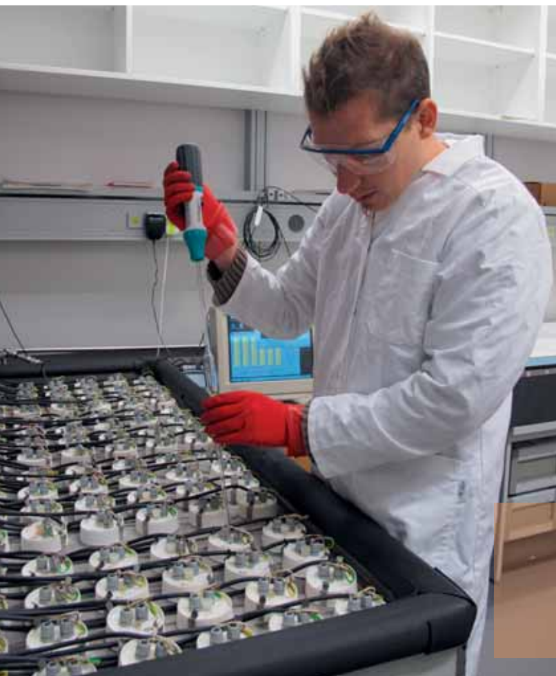
Abb. 3. Messung der CO_2 -Freisetzung im Inkubationsversuch an der Respicond-Anlage (A. Nordgren Innovations AB, Bygdeå, Sweden). Diese Methode ermöglicht die kontinuierliche Messung der CO_2 -Freisetzung für einen Zeitraum von Monaten. Dabei nutzt man die Eigenschaft einer Lauge, unter Bindung von CO_2 proportional an elektrischer Leitfähigkeit zu verlieren.
