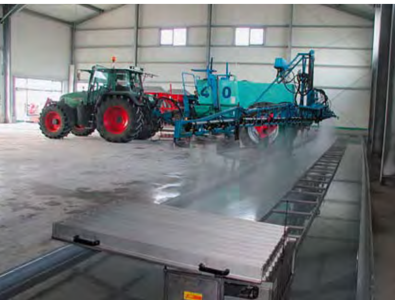
Technische Überprüfung eines Feldspritzgerätes (vergleichbar mit der TÜV-Hauptuntersuchung bei Kraftfahrzeugen): Verteilungsmessung mittels eines elektronischen Prüfstandes; hierbei wird das verspritzte Wasser aufgefangen und wieder in den Gerätetank zurückgeführt.
