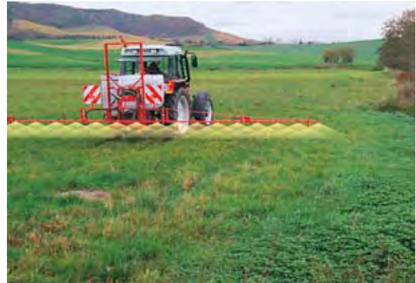
Modernes Feldspritzgerät, ausgestattet mit Flachstrahldüsen, die sich durch eine gute Verteilungsqualität und geringe Abdrift auszeichnen.
