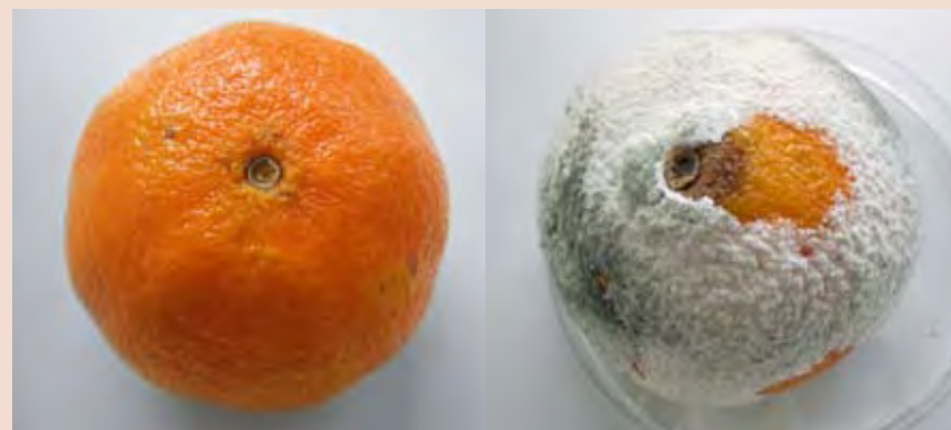
Abb. 6: Hemmung von oberflächlichem Wachstum von ochratoxinbildenden Pilzen durch Lichtbestrahlung.
