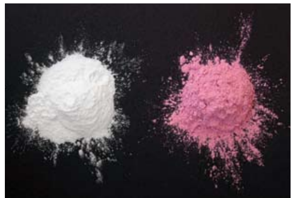
Abb. 1: Trägermaterial (links) und Goldkatalysator (rechts)
