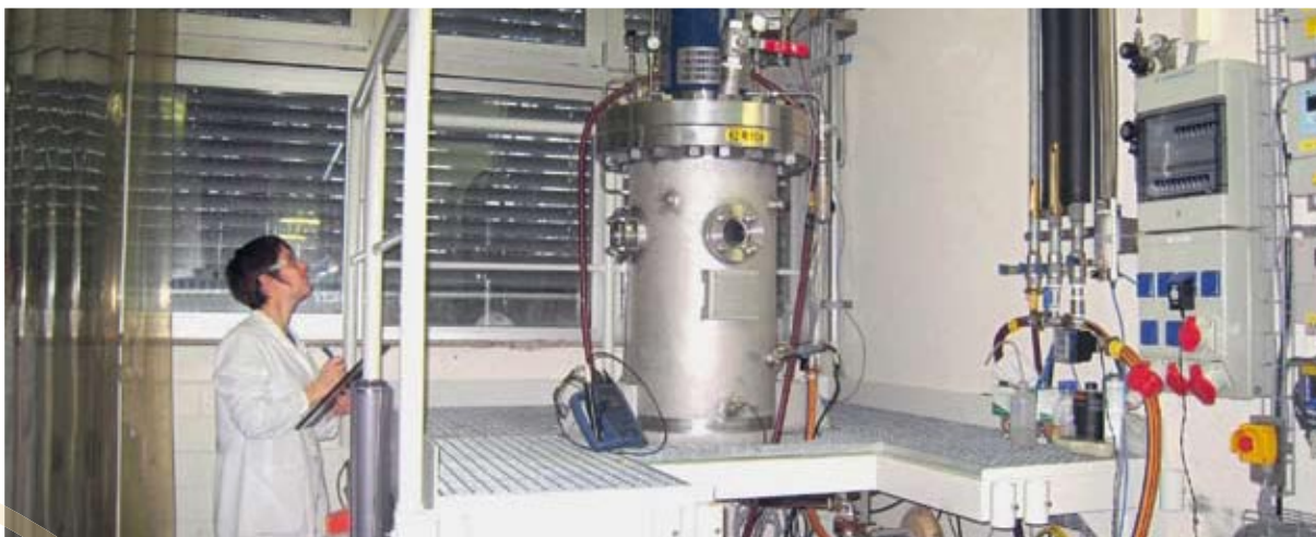
Abb. 6: Pilotreaktor zur Zuckeroxidation bei der Südzucker AG
