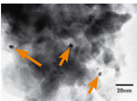
Abb. 2: Elektronenmikroskopische Aufnahme eines Goldkatalysators (Gold auf Aluminiumoxid). Die Goldpartikel sind mit Pfeilen markiert.
