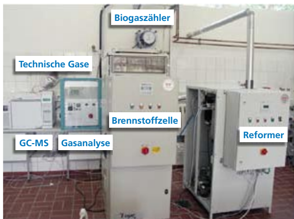
Abb. 5: Brennstoffzellen-Versuchsstand für den Betrieb mit Biogas
