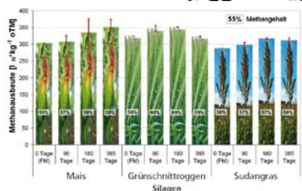
Abb. 1: Methanausbeuten von Mais-, Grünschnittroggen- und Sudangrashybrid-GPS nach unterschiedlicher Lagerdauer im Modell-Silo
